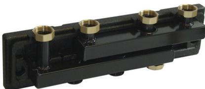
Collettore di distribuzione in acciaio per gruppi di rilancio completo di coibentazione in EPP compatibile con impianti sia con mandata da destra sia con mandata da sinistra. CON attacchi 1.1/2" M (4 m<sup>3</sup>/h)
