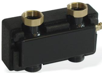
Separatore idraulico compatto in acciaio per gruppi di rilancio completo di coibentazione in EPP e predisposizione per sonda di temperatura ad immersione (manicotto 1/2" F – Ø 6,5 mm).
